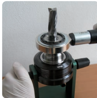
Serraggio ghiera con chiave dinamometrica
