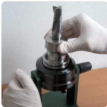
Inserimento del cono nello smontacono
