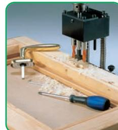
**I TRIMATIC 22 - 25 - 28** consentono di eseguire la sede per l'inserimento della cerniera angolare e della cerniera superiore.
